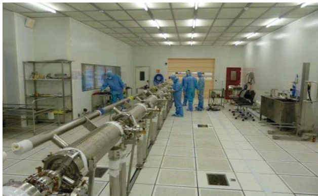
Assemblage des cryomodules XFEL
