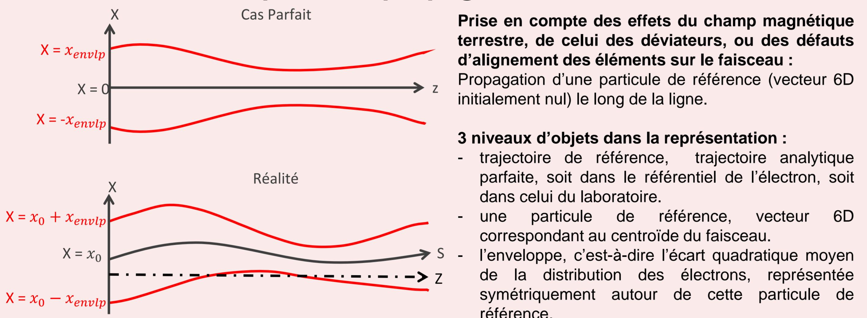
Prise en compte des effets du champ magnétique terrestre, de celui des déviateurs, ou des défauts d'alignement des éléments sur le faisceau : Propagation d'une particule de référence (vecteur 6D initialement nul) le long de la ligne.
