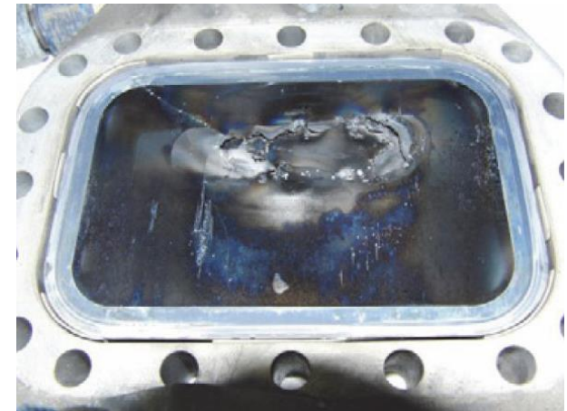
Implantation de protons → cloques de Be vaporisées par le faisceau à LENS (quelques kW)
