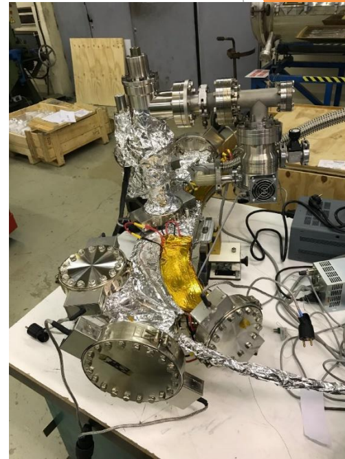
Chambre IP pompage et étuvage => 10-10mbar
