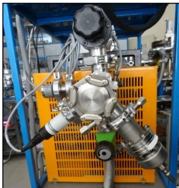
Installation de test avec détecteur et jauges
