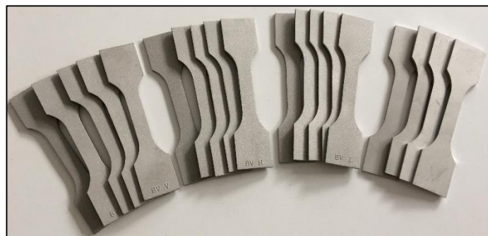
4 séries d'éprouvettes 0°, 45°, 90° et témoins J. Laurence (CPPM), A. Gonnin (LAL), BV Proto
