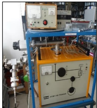
Installation de test avec détecteur et jauges
