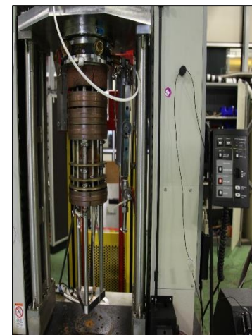
Machine de traction Instron de 150 kN - 2 cryostats
