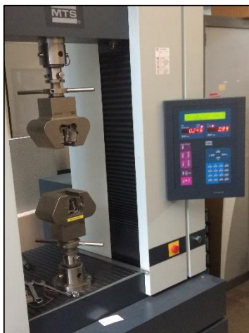
Machine de traction MTS-30M de 150 kN
